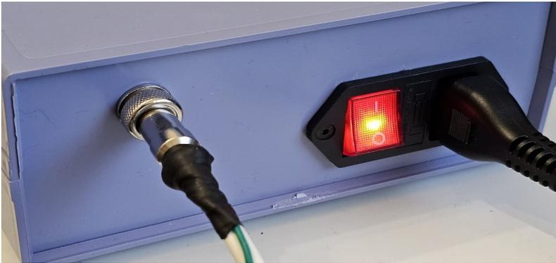
A l'arrière du boîtier connectez le ruban de LED de la même façon. Connectez en dernier le câble secteur.
