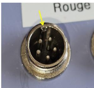
Chaque prise est équipée d'un détrompeur situé en haut de la prise.
