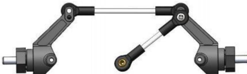
La longue biellette est fiée dans le trou supérieur, connectée aux coupelles de direction des deux côtés, l'espacement des trous est de **65mm**, s'il est différent, réglez la biellette avant de la monter.
