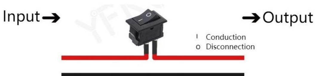
Câblage de l'interrupteur : le fil noir va directement de l'alimentation à la carte mère, et un interrupteur est connecté en série au milieu du fil rouge pour pouvoir couper l'alimentation.
