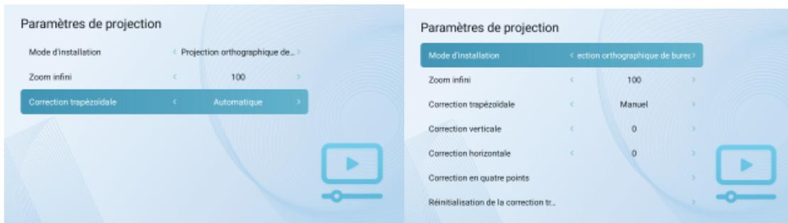
(3) Correction du trapèze à quatre points: dans l'interface principale, déplacez le curseur sur Réglages, ouvrez Réglages—Réglage de projection- sélectionnez Correction manuelle du trapèze -Correction du trapèze à quatre points (ou appuyez sur la touche Menu pour afficher la barre de menus- sélectionnez Correction du trapèze - Correction du trapèze à quatre points). Il faut utiliser cette fonction lorsque l'appareil est incliné vers la gauche et vers la droite en même temps.
