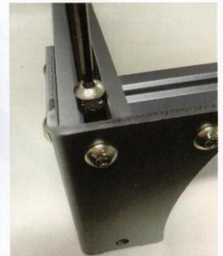
Serrez les vis et maintenez le côté long de l'écrou en T perpendiculaire à la rainure.
