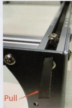
Ne serrez pas l'écrou en T, tirez la courroie avec votre main pour serrer la courroie
