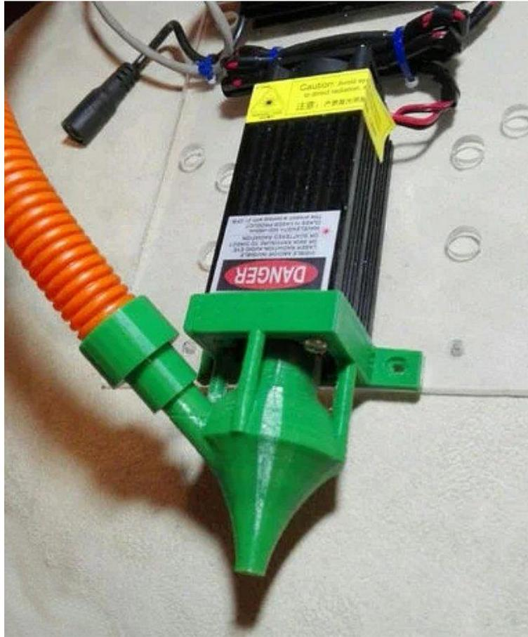
La présence ou le montage d'un "air-assist" comme celui-ci (trouvé sur [Thingiverse](https://www.thingiverse.com)) permet d'injecter de l'air sous pression au niveau de l'impact du faisceau laser sur l'objet à graver/découper. Les poussières sont chassées et ne peuvent plus se déposer sur la lentille. Attention cependant, un air assisté en PLA ou en matière plastique peut être source d'incendie, à proximité du point chaud créé par le LASER.
