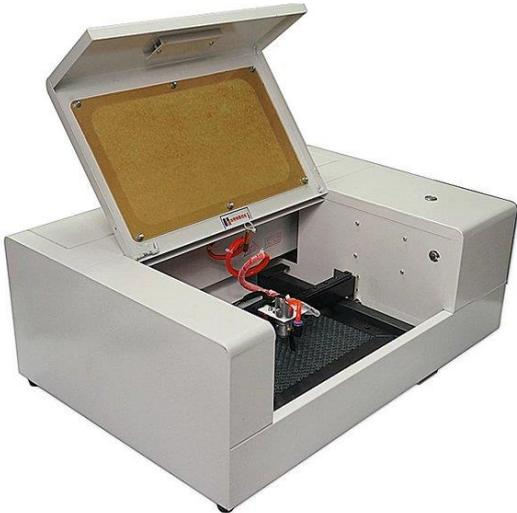
Sur cette découpe LASER par exemple, le couvercle comporte une vitre qui permet d'observer ce qui se passe dans la machine, tout en bloquant la longueur d'onde du LASER, l'empêchant d'atteindre l'extérieur. Quand le couvercle est ouvert, la machine s'arrête pour que l'opérateur soit en sécurité.
