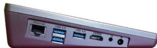
▲ Photo 1 Brochette de prises, de gauche à droite : réseau, USB 3, HDMI, casque, chargeur de batterie.
