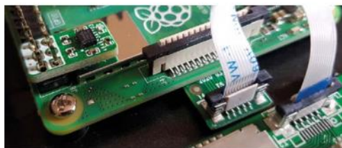
▲ Photo 3 Détecteur de position enfiché sur le port GPIO. La carte SD du Raspberry Pi est remplacée par un adaptateur qui renvoie vers le connecteur extérieur.
