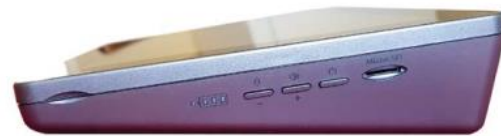
▲ Photo 2 De gauche à droite : voyant A/M, indicateur de charge batterie, réglage de luminosité, réglage de volume, bouton A/M, carte micro-SD.
