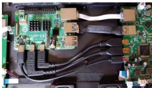
▲ Photo 4 Intérieur de la tablette. À gauche le Raspberry Pi 4, à droite la carte mère, en bas les deux haut-parleurs.
