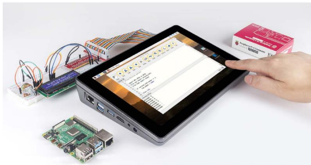
▲ Photo 5 Grâce à l'accès au GPIO on peut utiliser Raspad3 pour apprendre à coder avec des composants externes.
