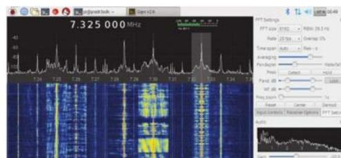
▲ Figure 8. Réception sur la bande des 40 m (7 MHz) sur le Raspberry Pi. (© gqrz.dk)
