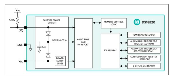
Le thermomètre numérique DS18B20 fournit des mesures de température en degrés Celsius avec une valeur codée de 9 à 12 bits. Sa gamme de mesure s'étend de -55°C à +125°C avec une précision de  $\pm 0,5$ °C.
