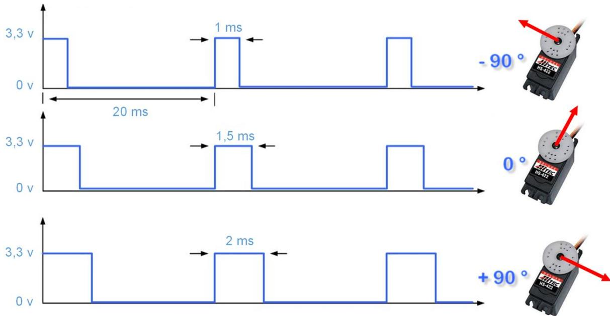
Les servomoteurs utilisés en radiomodélisme sont commandés par un signal à 50 Hz (période = 20ms). La position de l'axe du servomoteur est asservie à la largeur du créneau positif du signal.
