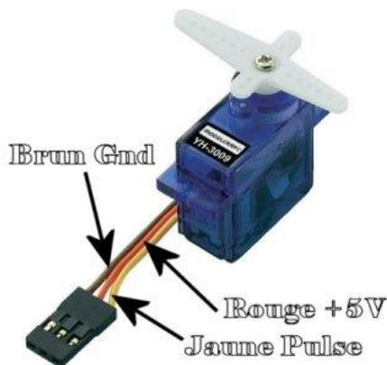
Relier la broche 2 (+5v) du connecteur GPIO au fil V+ du servo
