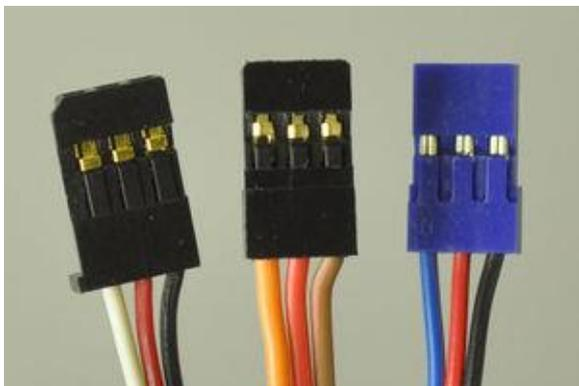
Les servomoteurs sont équipés de prises à 3 contacts. En fonction de la marque, les couleurs de fils peuvent différer. Il n'y a pas de norme à ce sujet.
