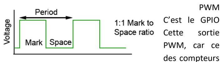
Il est possible de dédier les autres sorties GPIO au PWM. La gestion est alors assurée par logiciel. Le noyau Linux utilisé n'étant pas « Temps réel », la régularité du signal est perturbée par le partage des ressources au niveau du processeur. On voit alors apparaître du « jitter » (légères variations du signal : fréquence et rapport cyclique) ce qui va se traduire par de petits mouvements ou des vibrations en sortie de servo.
