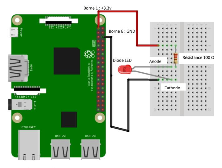
On teste d'abord le bon fonctionnement du montage en reliant la LED entre +3.3v et masse.
