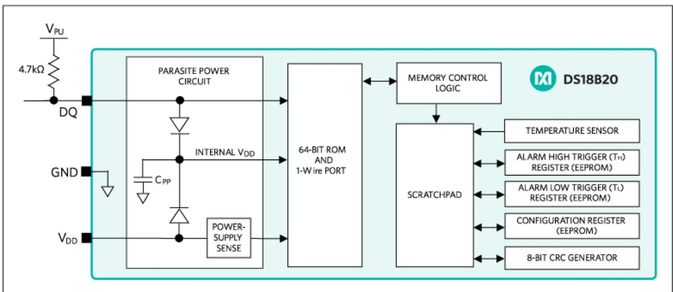
Le thermomètre numérique DS18B20 fournit des mesures de température en degrés Celsius avec une valeur codée de 9 à 12 bits. Sa gamme de mesure s'étend de  $-55^{\circ}\text{C}$  à  $+125^{\circ}\text{C}$  avec une précision de  $\pm 0,5^{\circ}\text{C}$ .
