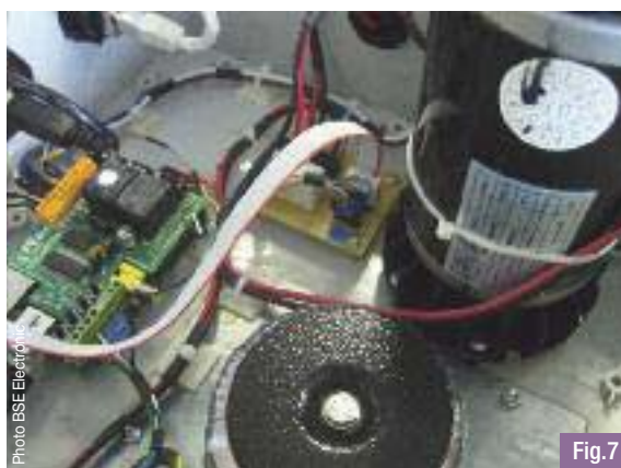
Photo BSE Electronic Raspberry Pi dans le banc test de BSE electronic
