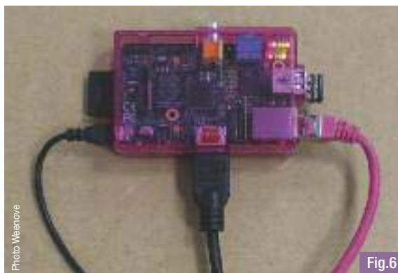
Photo Weenove Dissimulé sous la table le Raspberry Pi est maintenu par un adhésif double face
