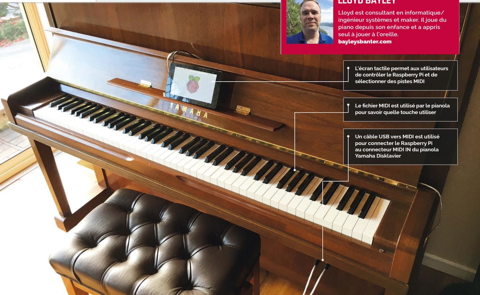
L'écran tactile permet aux utilisateurs de contrôler le Raspberry Pi et de sélectionner des pistes MIDI
