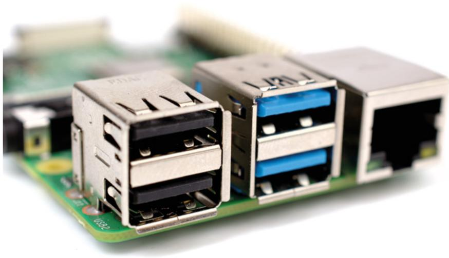
▲ **Figure 1-6** : Les ports USB d'un Raspberry Pi
