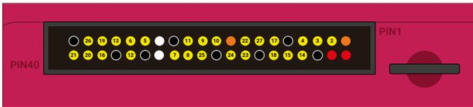
Le port GPIO du modèle Raspberry Pi 400 dispose exactement des mêmes broches, mais il est installé à l'envers par rapport aux autres modèles de Raspberry Pi. Le présent schéma suppose que vous faites face au port GPIO depuis l'arrière de votre Raspberry Pi 400. Vérifiez toujours attentivement votre câblage lorsque vous connectez quoi que ce soit au port GPIO de votre Raspberry Pi 400 (il est très facile d'oublier, malgré les étiquettes « Pin 40 » et « Pin 1 » sur le boîtier !)
