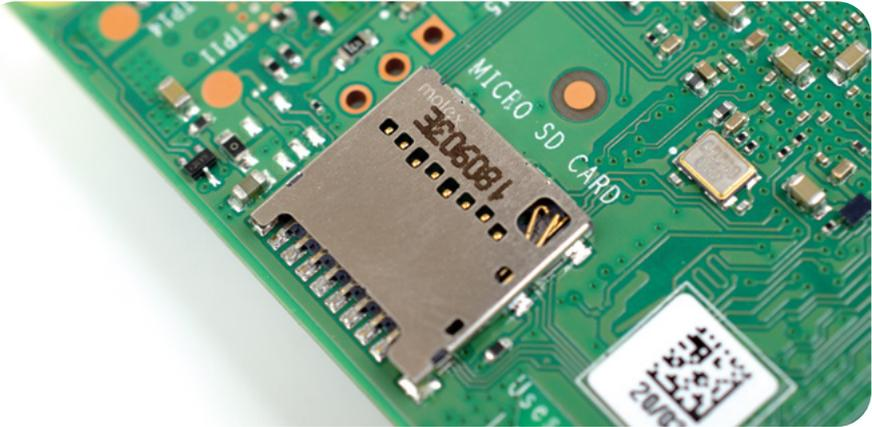
▲ **Figure 1-15** : Connecteur carte microSD d'un Raspberry Pi
