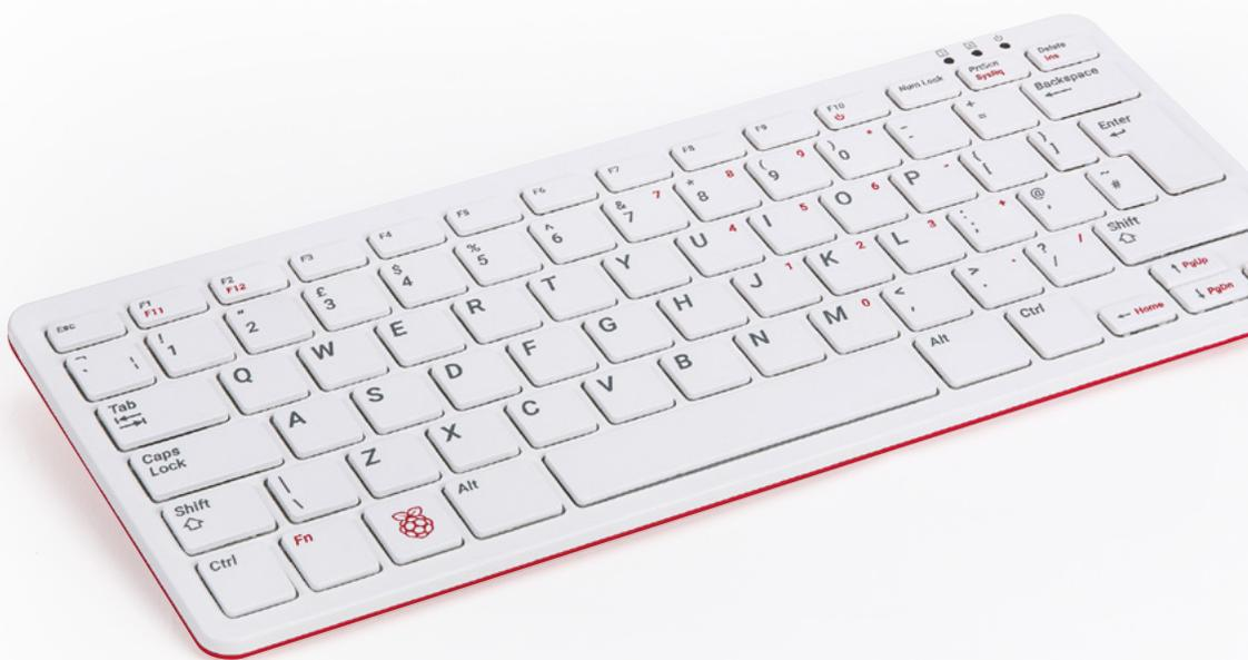
▲ **Figure 1-16** : Le modèle Raspberry Pi 400 possède un clavier intégré
