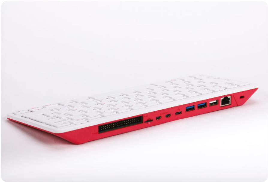
▲ **Figure 1-17** : Les ports se trouvent à l'arrière du Raspberry Pi 400
