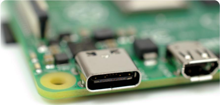
▲ **Figure 1-11** : Port d'alimentation de type C USB d'un Raspberry Pi
