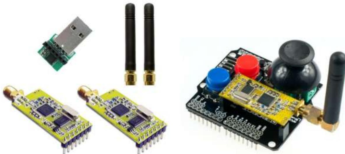
Les APC220 sont livrés par paire, avec les antennes et un adaptateur USB pour les essais avec un PC et le paramétrage des modules.
