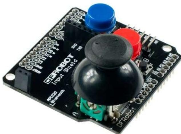
Le joystick est équipé de deux potentiomètres et d'un contact. La carte offre deux poussoirs supplémentaires qui pourront servir pour des accessoires (feux, sirène ?). De plus ce joystick est prévu pour accueillir une carte UHF APC220 d'une portée en extérieur de 1000 mètres.
